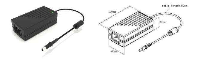
电源适配器符合欧洲质量检测CE标准,可输出稳定的5VDC,输入电压范围在85-264VAC,频率47-63HZ。拥有IEC 60320标准的插口和0.5米长易拔插线缆。与电源插头兼容的耳机接口可在附件-接口中找到。
