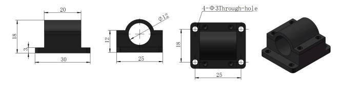
这是一款为直径12mm二极管模组设计的简易散热底座。松开4颗定位螺钉,移开模组底座的上半部,放入激光器。再拧紧螺钉固定激光器。底座预留了4个通孔方便用户将激光器固定在平直且散热良好的表面。
